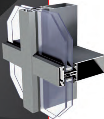
rez stĺpikom systému MC WALL
